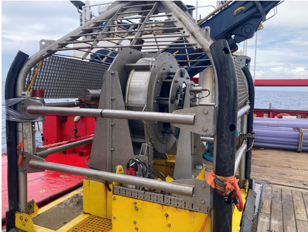
Figura 23. Imagen del cNODE instalado en el CPTU.
