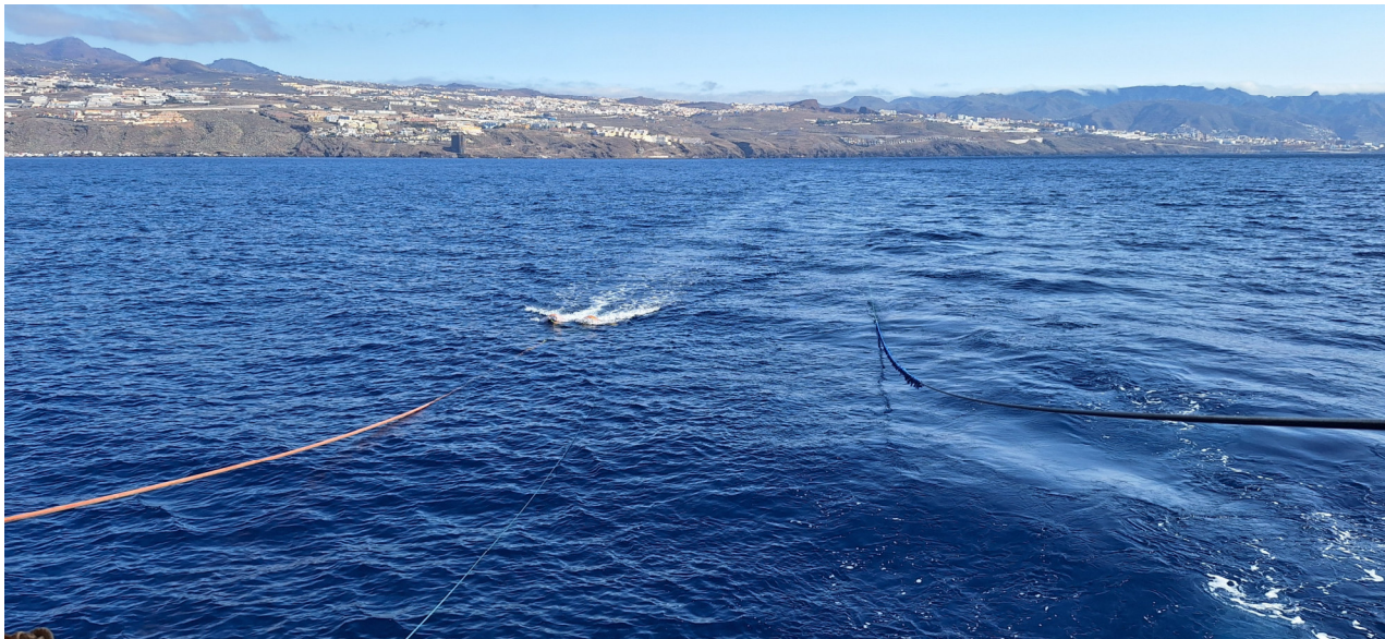
Figura 5. Disposición del streamer y del sparker remolcado desde el tangón. Puede verse tb la estela del barco.
