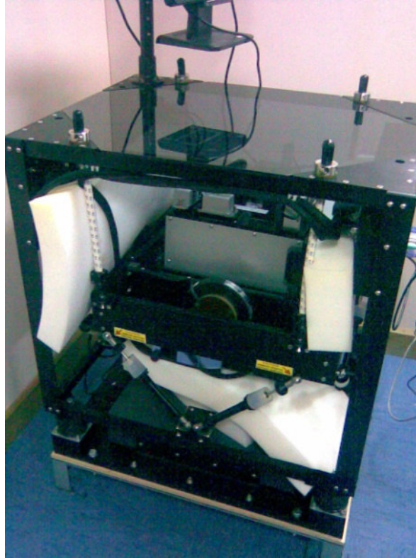
Figura 28. Gravímetro marino Lacoste & Romberg instalado a bordo del Sarmiento de Gamboa
