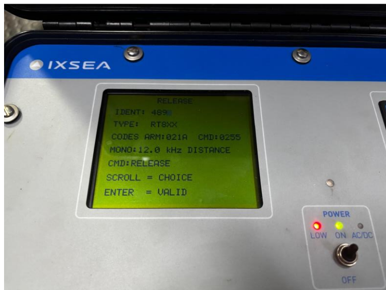
Figura 38. Parámetros de liberación empleados en el sistema de control remoto acústico.
