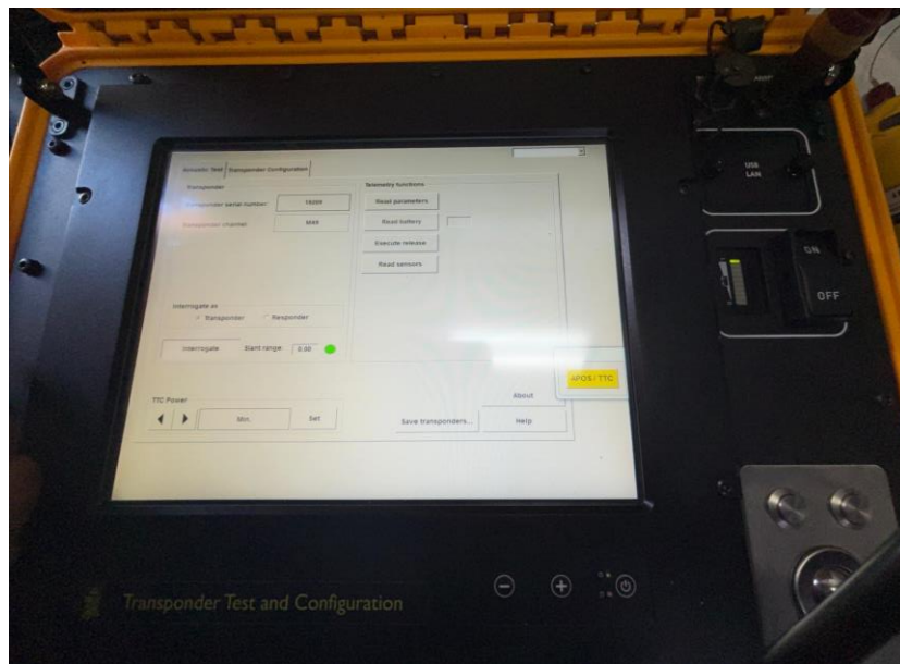
Figura 34. Comprobación del cNODE (M49 S/N 19209) en el TTC.
