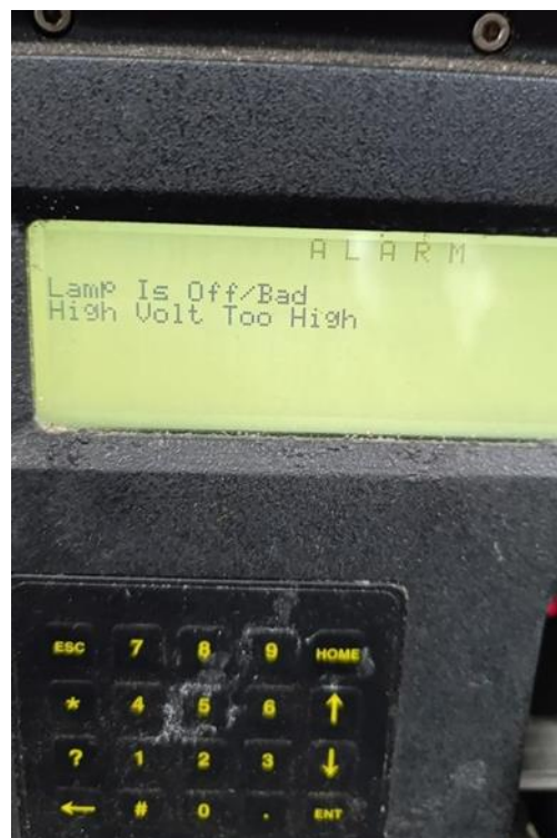
Ilustración 3. Alarmas activas en el fluorómetro del continuo.
