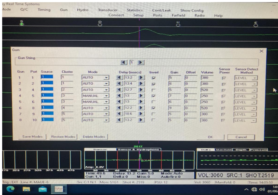
Figura 7. Control de la instrumentación y visualización de los tiempos de retraso/adelanto en cada cañón por disparo, forzándolos a implosionar todos juntos en el "aim point".
