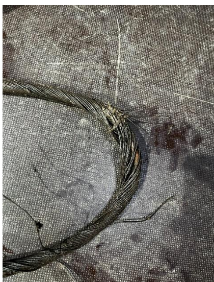
Trozo de cable cortado con la parte dañada
