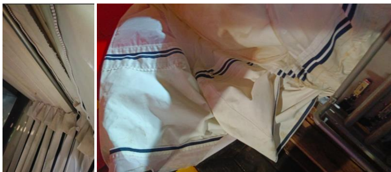
Figura 6. Detalles de la rotura de las redes de la Multinet (Hydrobios).
