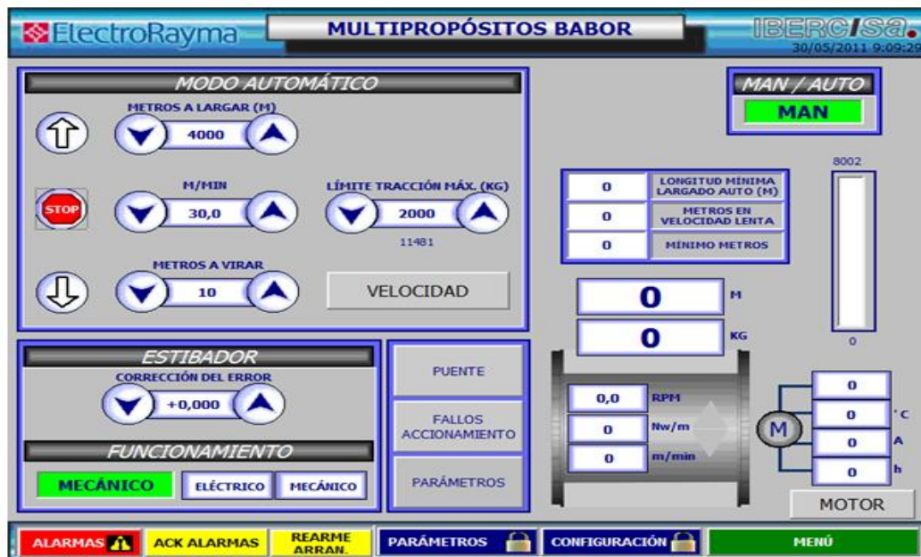
Figura 9. Pantallazo del control remoto de el chigre multiproposito
