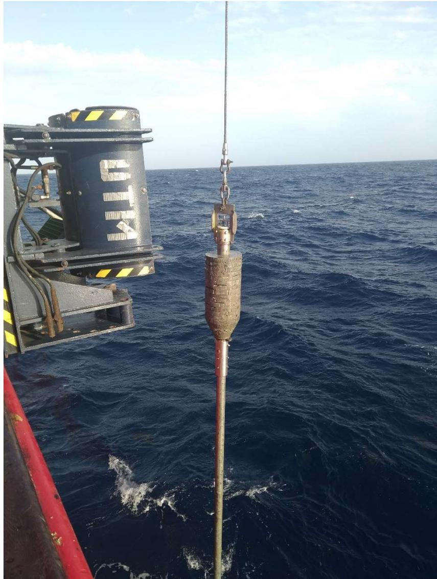
**Figura 4:** Testificador de gravedad del Sarmiento de Gamboa.
