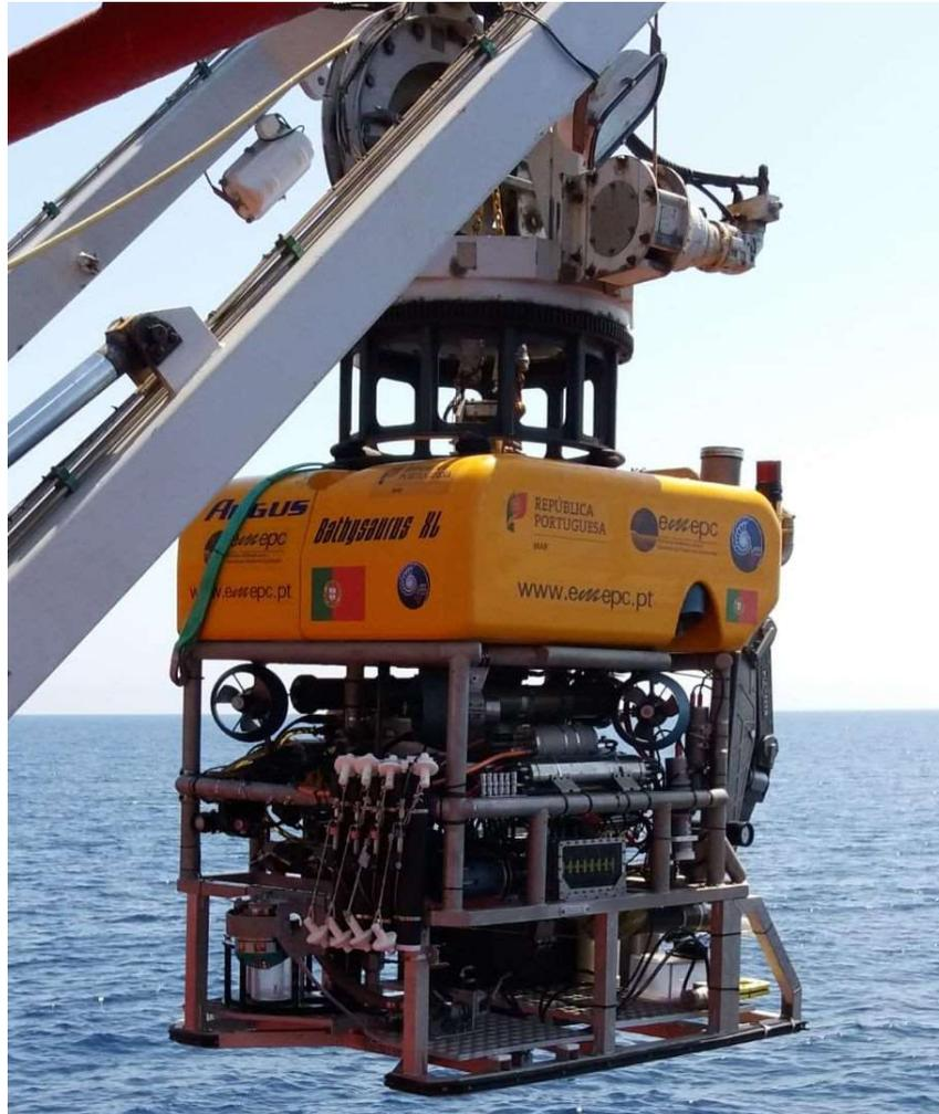
**Figura 5:** despliegue del ROV modelo Argus Bathysaurus XL en el BO Sarmiento de Gamboa.
