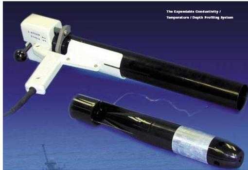
tales como temperatura (sondas XBT), velocidad del sonido (sondas XSV), conductividad y salinidad (XCTD). El sistema realiza la adquisición, presentación y almacenamiento de los datos en tiempo quasi-real, permitiendo una presentación posterior de los datos para su análisis.
