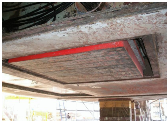
Foto . Imagen del transductor de la Topas en el BIO Hespérides
