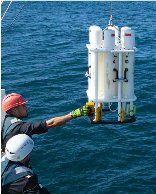
traza el equipo investigador cuenta con una roseta – CTD con winche propio de Kevlar de pequeñas dimensiones. Se requiere apoyo técnico para su montaje en cubierta, pero no para su manipulación.
