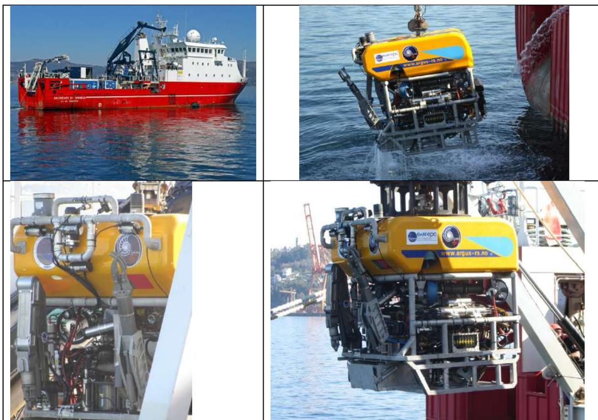
**FIGURA 3:** Vistas frontales y laterales de ROV *Luso* durante las maniobras de arriado e izado a bordo del B/O *Sarmiento de Gamboa* en la campaña SUBVENT-2.
