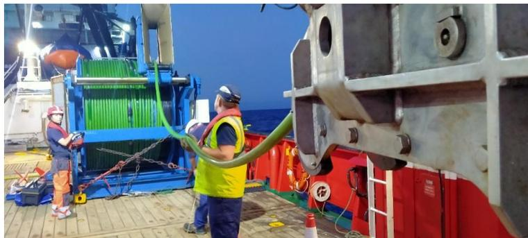
A lo largo de las secciones del streamer se van colocando los compases y birds que ayudan al posicionamiento del streamer en el agua, estos se colocan en el streamer tras la pasteca durante el largado del streamer.
