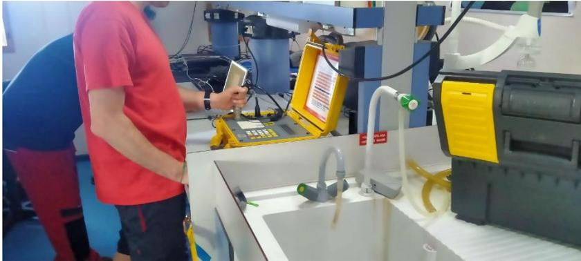
Técnicos lanzando la señal al OBS desde la unidad de cubierta ORE OFFSHORE en el laboratorio con apoyo de un software.
