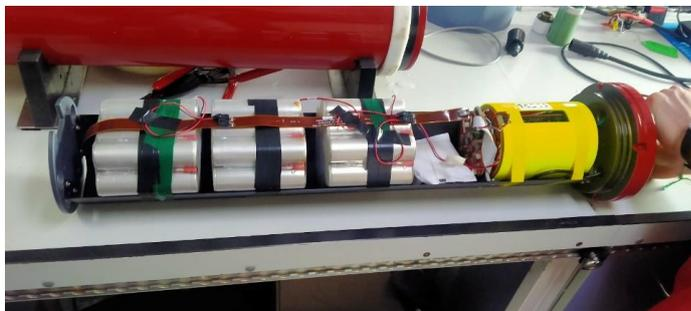
En esta foto se pueden apreciar las baterías de litio, si se tratase de sismica activa (con fuente emisora de señal (cañones o sparker)), se utilizarían baterías alcalinas.
