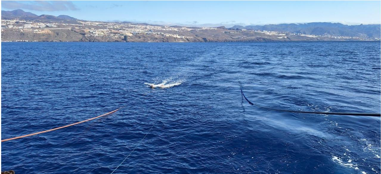
Figura 5 . Disposición del streamer y del sparker remolcado desde el tangón. Puede verse tb la estela del barco.
