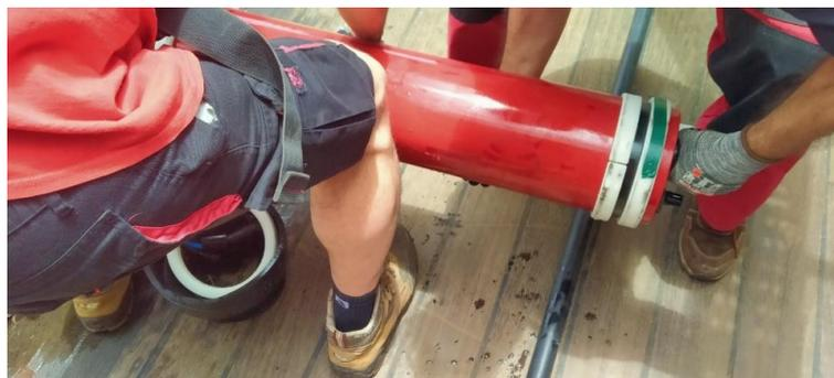
Una vez extraído el cilindro, se procede a abrirlo, para extraer la tarjeta con los datos, conectar el data logger a un software para extracción de datos y desconectar las baterías.
