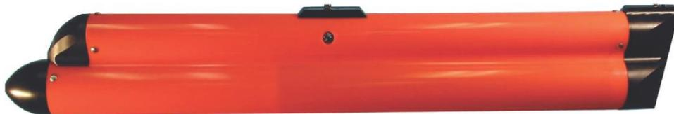
Cuando se alcanza una presión que supere las 70 psi (aproximadamente 48 metros de profundidad), automáticamente se libera el globo o “airbag” contenido en el cilindro inflándose con CO<sub>2</sub>. Esto permite la recuperación del “streamer” en caso de accidente, elevándolo a superficie. Para un “streamer” de las características del Geoeel<sup>®</sup> se recomienda la instalación de un dispositivo cada 100-150 metros.
