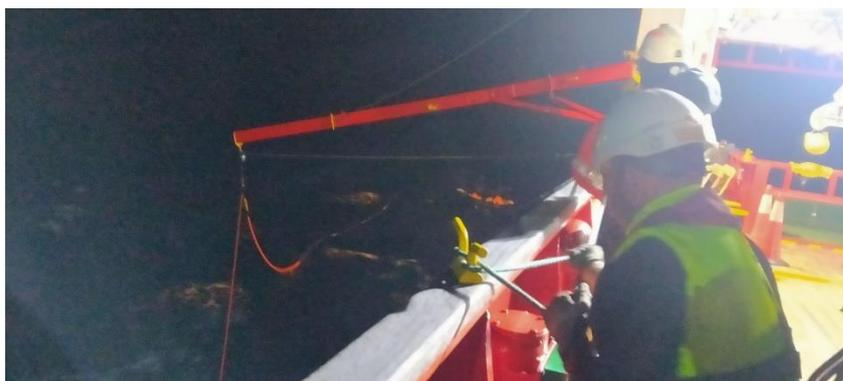
En la maniobra de recuperación del sparker, la recogida del equipo hasta el costado del buque se realiza tirando de un cabo a mano, este es el momento más crítico de la maniobra ya que debemos evitar que el equipo derive hacia la popa del barco o se pueda meter debajo del buque por la zona de la aleta.
