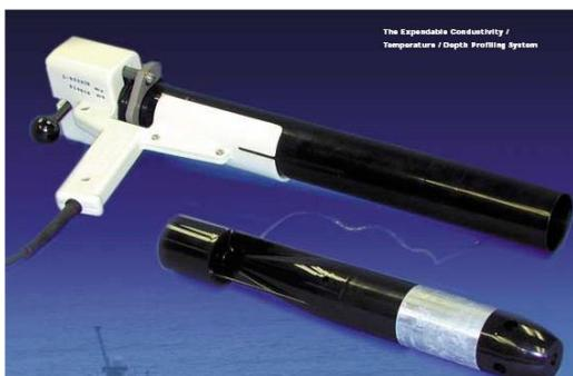
El sistema de adquisición de datos oceanográficos SIPPICAN MK-21 utiliza un PC estándar y un conjunto de sondas desechables para medir y visualizar parámetros físico-químicos del océano, tales como temperatura (sondas XBT), velocidad del sonido (sondas XSV), conductividad y salinidad (XCTD). El sistema realiza la adquisición, presentación y almacenamiento de los datos en tiempo quasi-real, permitiendo una presentación posterior de los datos para su análisis.
