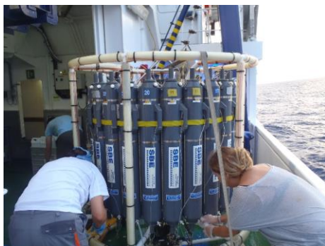
Figura 2 Conjunto de CTD y colector de agua (roseta) para el muestreo vertical de la columna de agua a distintas profundidades.
