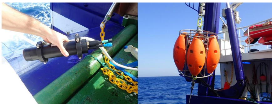
Figura 5. Foto de la estructura que contiene los sensores y la colocación de un sensor en la línea de fondeo.
