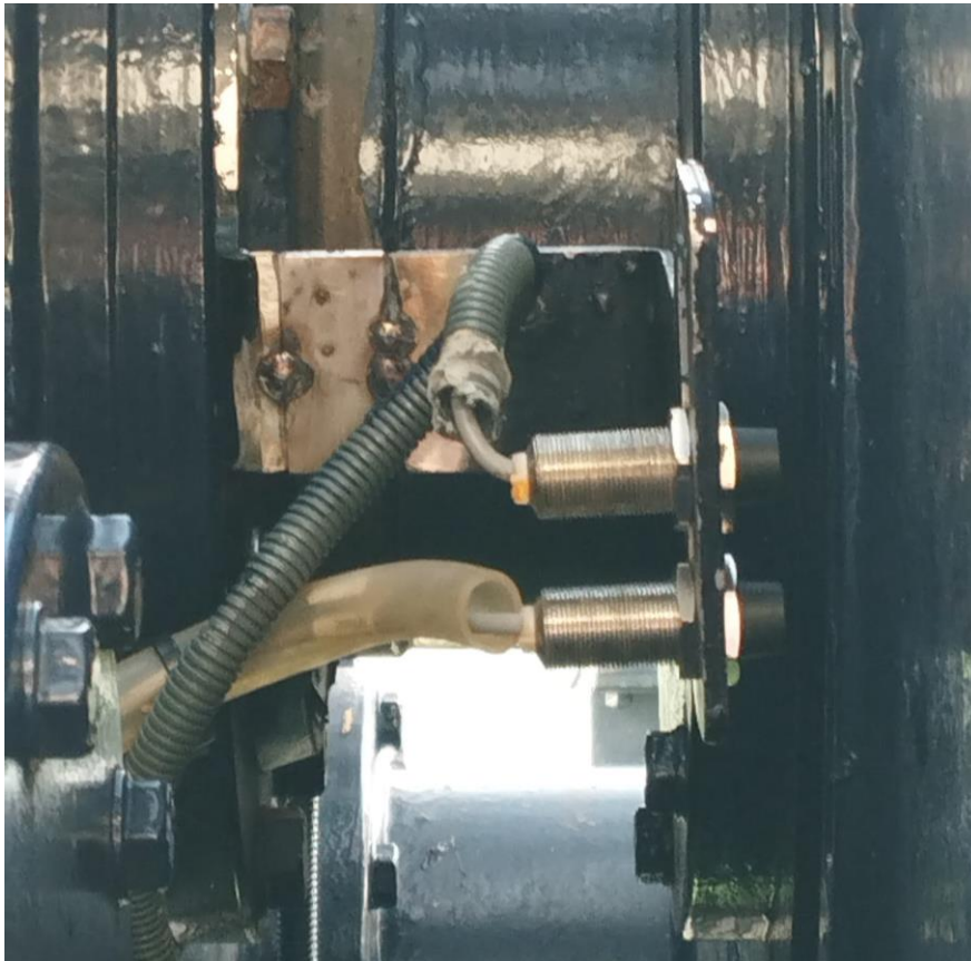
Imagen inductivos montados y ajustados con la nueva chapa.
