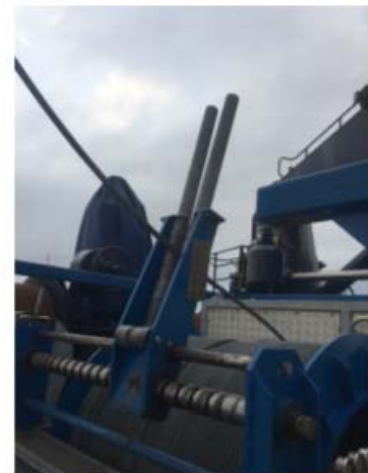
Detalle del estibador ampliado para poder tomar el ángulo elevado de salida
