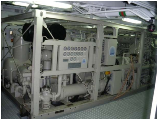
Fotos 6 y 7. Compresor LMF 25/138-207-E50 instalado a bordo del Sarmiento de Gamboa.
