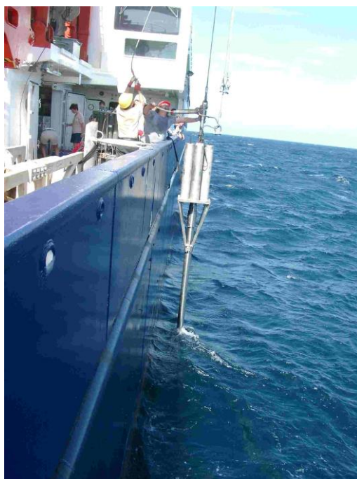
Figura 5: La figura superior muestra la maniobra de posicionamiento en estación de la sonda por la banda de estribor. La figura inferior muestra la sonda una vez posicionada verticalmente y preparada para ser largada.
