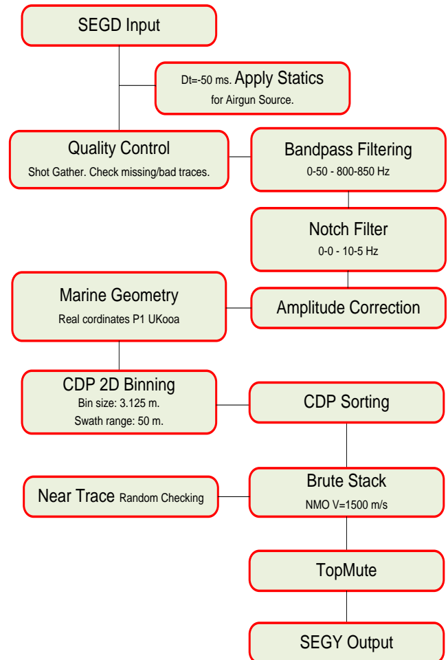
Figura 24. "Flow" del preprocesado sísmico realizado a bordo por UTM-CSIC.
