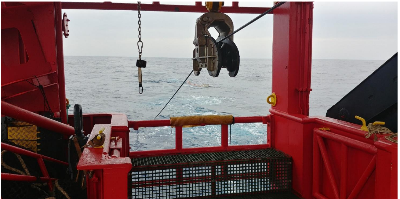
Figura 26 . Streamer desplegado con pasteca dedicada.
