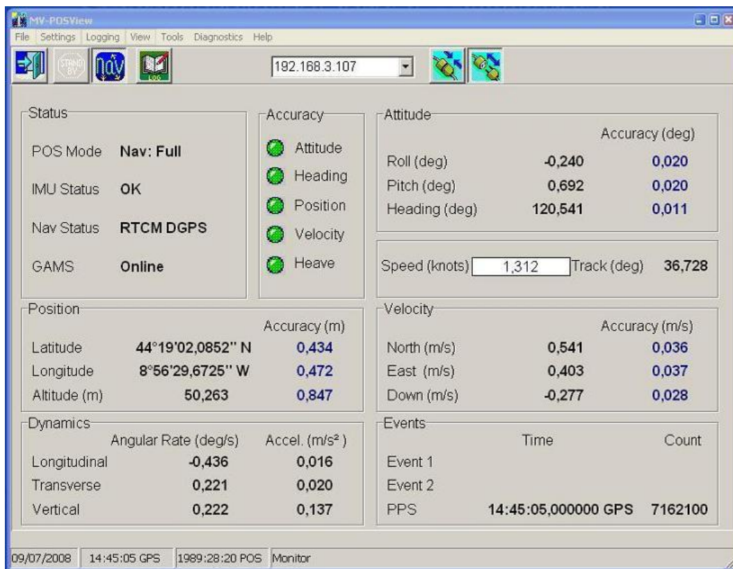
Ilustración 2. Software de control. POS/MV
