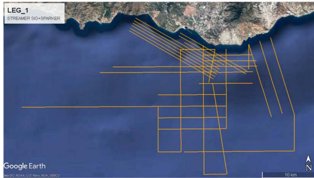
Foto 4. Zona de trabajo y líneas sísmicas realizadas en el primer Leg.
