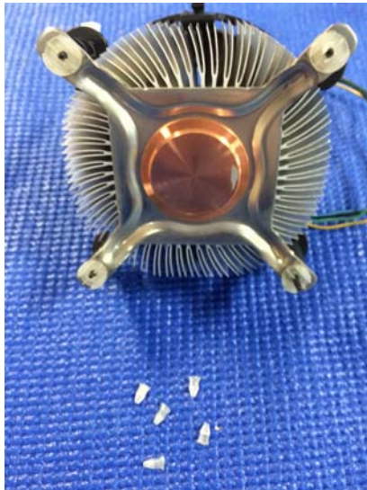
Foto 19. Ventilador y pestañas rotas
