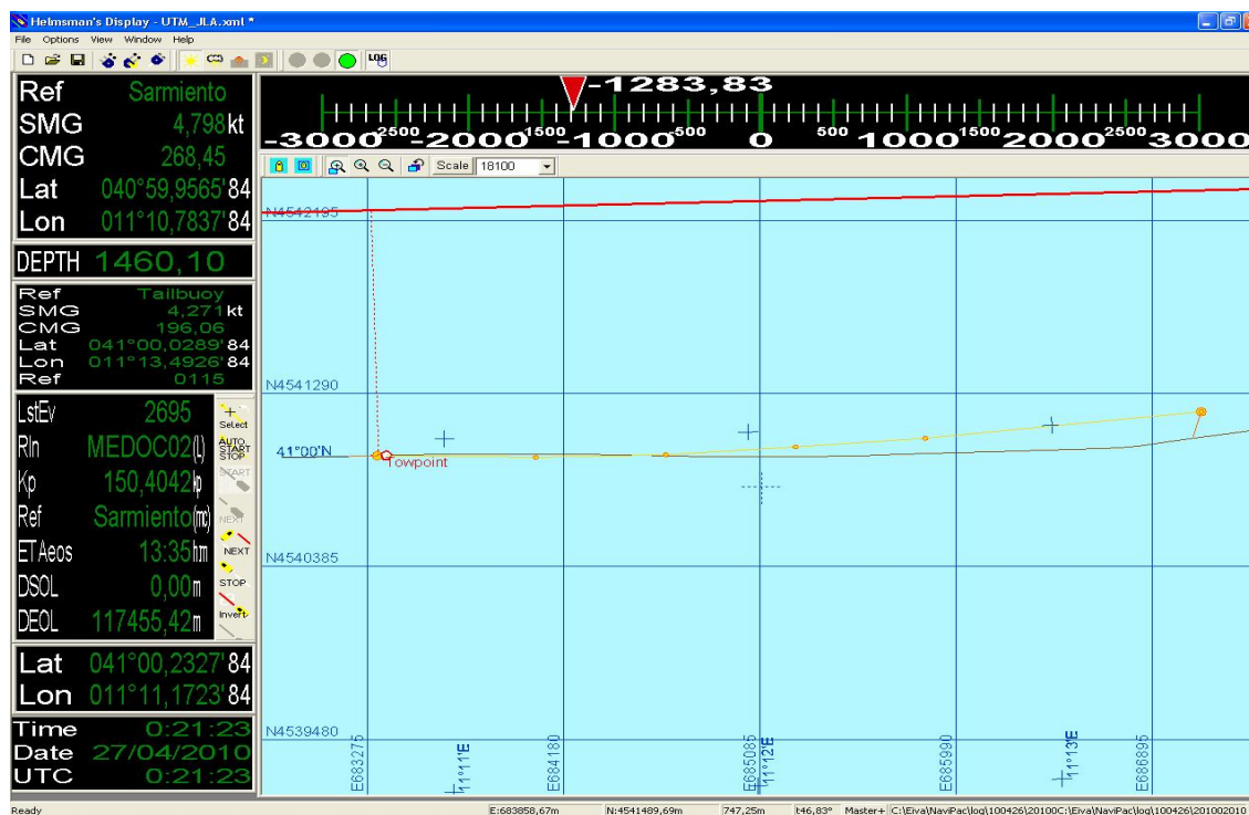
Figura 4. Visualización y control a tiempo real de la posición del “streamer” y equipos auxiliares.
