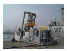
penetración del vibrocorer dependerá de la fuerza de la cabeza vibradora, de la frecuencia de vibración y de las características geotécnicas del sedimento, pudiendo conseguir un máximo de recuperación de 5.8 metros Dispone de una estructura desmontable para facilitar la extracción de los tubos y darle estabilidad en zonas de pendiente o de fuertes corrientes.
