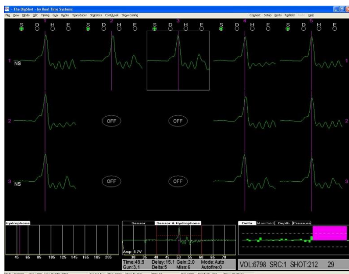
Detalle de funcionamiento del controlador de cañones y sincronía en la generación de la fuente sísmica.
