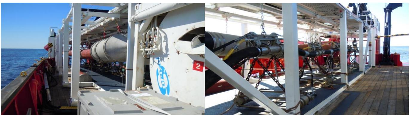
Foto 2. Estructura de cañones diseñada y fabricada por UTM.
