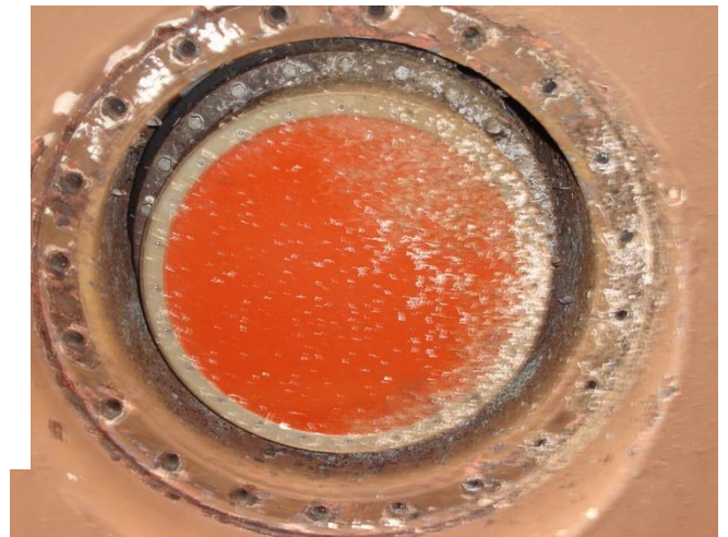
Imágenes del Doppler de 75 KHz, a la derecha el transductor instalado en la quilla.
