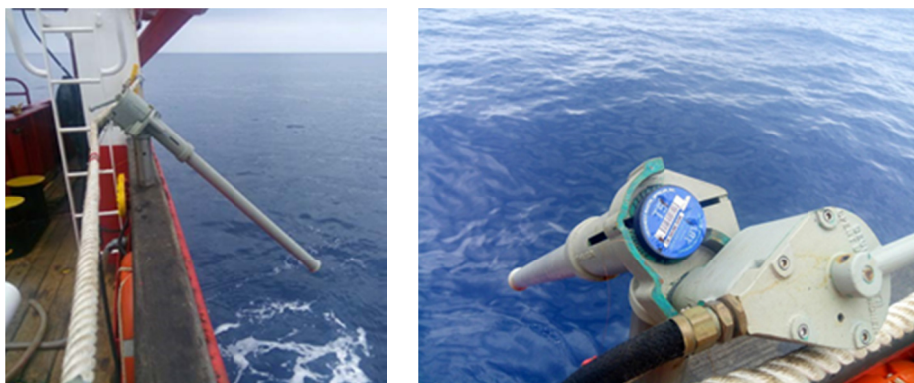
Figuras 35 y 36. Imágenes de la lanza de las sondas batitermográficas
