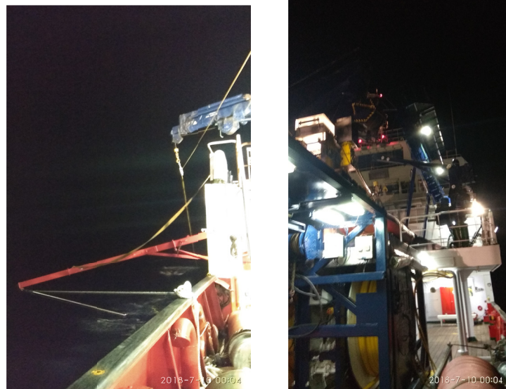
Figuras 40 y 41. Cable de tiro del magnetómetro y Chigre del mag sobre la estructura de cañones
