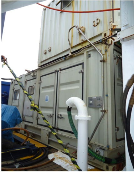
Fotos 4 y 5. Compresor LMF 25/138-207-E50 instalado en cubierta del Sarmiento de Gamboa.
