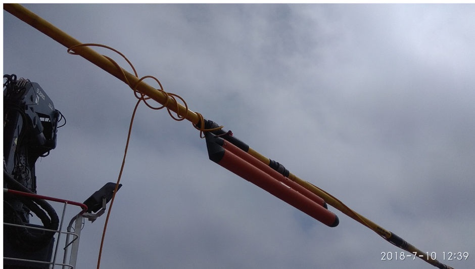
Figura 44. Línea de tiro del magnetómetro entrelazada con en girocompás del streamer
