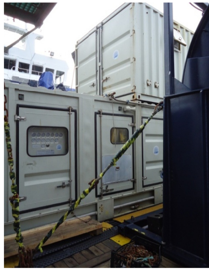
Fotos 4 y 5. Compresor LMF 25/138-207-E50 instalado en cubierta del Sarmiento de Gamboa.
