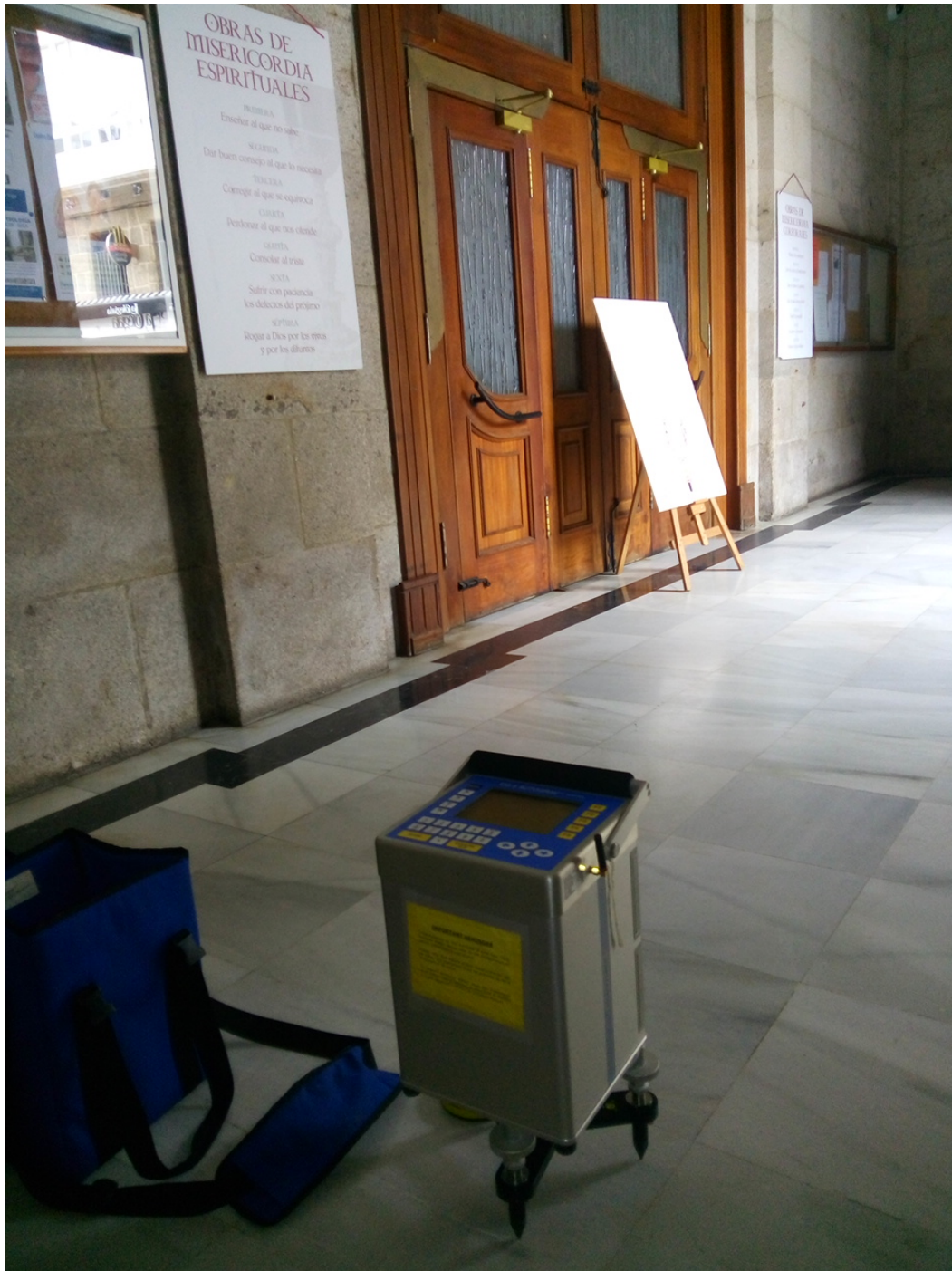
Gravímetro portátil sobre el punto gravimétrico de la concatedral de Vigo.
