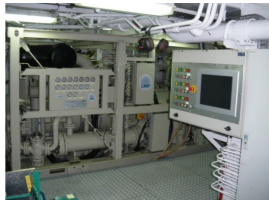
Fotos 2 y 3 . Compresor LMF 25/138-207-E50 instalado a bordo del Sarmiento de Gamboa.
