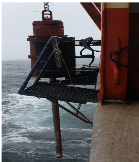
Foto 5 .Detalle instalación "gravity corer".
