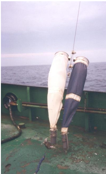
Fotos de Redes tipo:A)Red bongo (izquierda ) ; B) MIK (derecha) y C) Paironet
