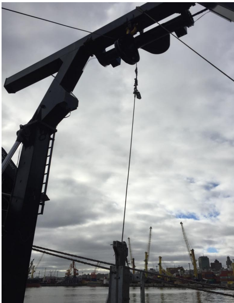
Foto. 1.- Margen que nos dejaba el box corer una vez disparado con las pasteca del pórtico.
