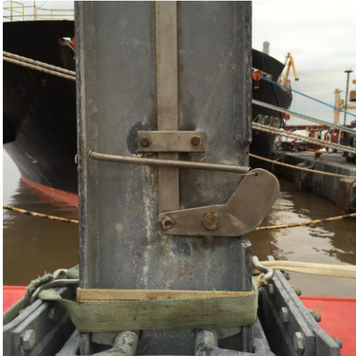
Foto 3. Muelle añadido para evitar el retorno de la cuchara.
