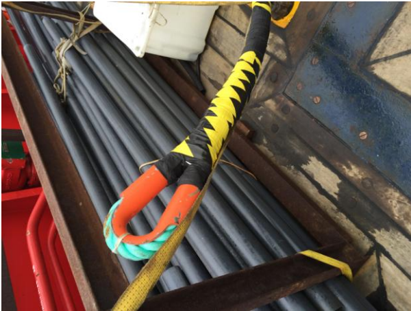
Foto. 2 Guardacabos hecho a la estacha del chigre del pórtico
