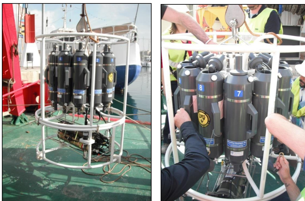
Figura 7. SBE 32 para toma de muestras de hidroquímica (Fuente: elaboración propia)
