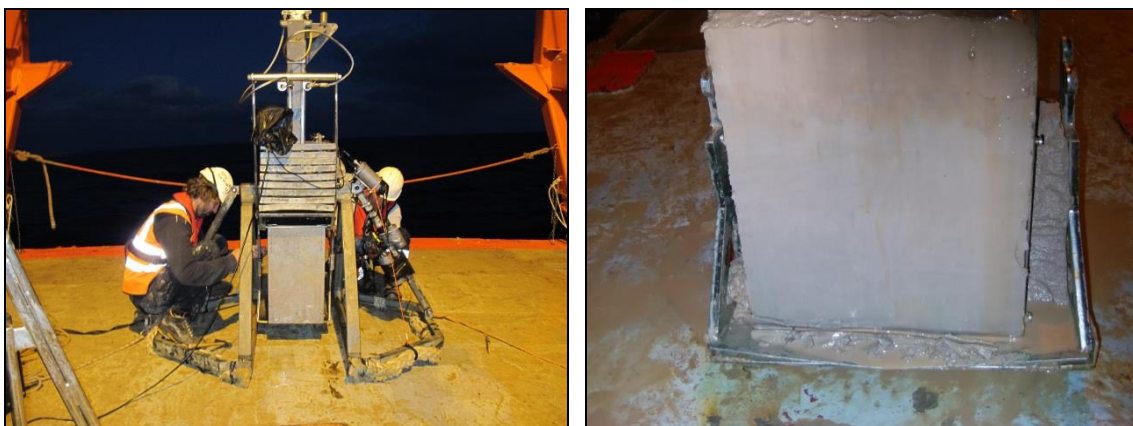
Figura 9. Draga Box-corer (Fuente: Tecnoambiente)
