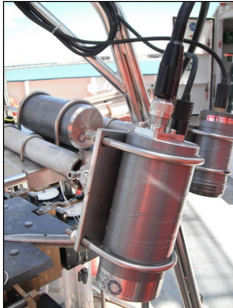
Figura 16. Cámara SubC Control 1Cam, foco y batería acoplados al sistema de muestreo (Fuente: Tecnoambiente)
