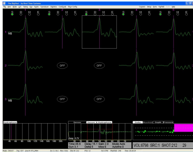
Figura 7. Detalle de funcionamiento del controlador de cañones y sincronía en la generación de la fuente sísmica.
