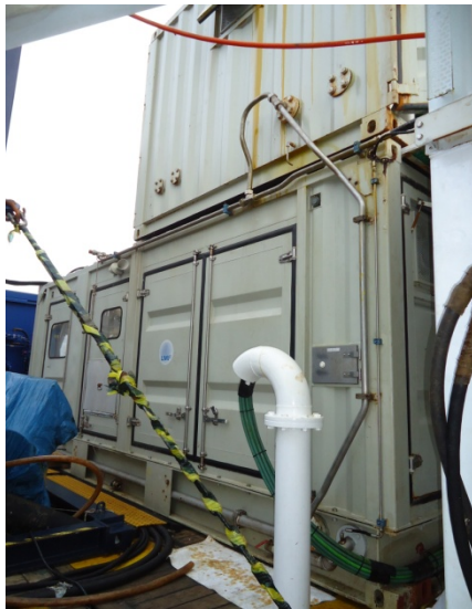
Fotos 3 y 4. Compresor LMF 25/138-207-E50 instalado en cubierta del Sarmiento de Gamboa.
