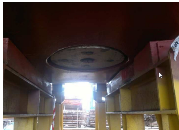
FOTO 12. IMAGEN DEL TRANSDUCTOR DEL POSIDONIA Y SU EMPLAZAMIENTO EN EL CASCO DEL BARCO.
