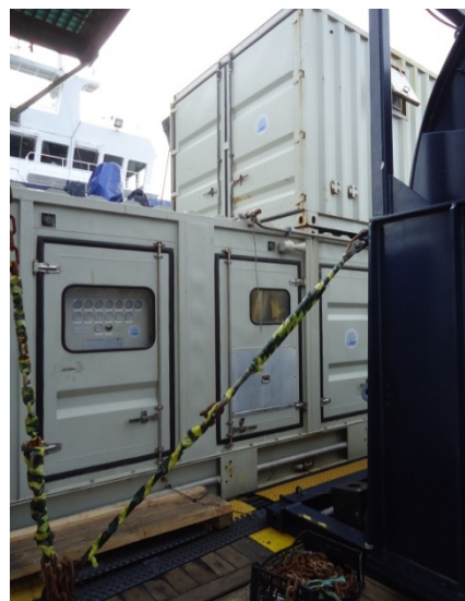
Fotos 3 y 4. Compresor LMF 25/138-207-E50 instalado en cubierta del Sarmiento de Gamboa.
