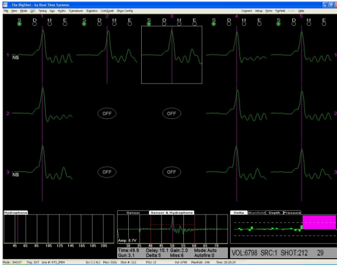
Figura 6. Detalle de funcionamiento del controlador de cañones y sincronía en la generación de la fuente sísmica.
