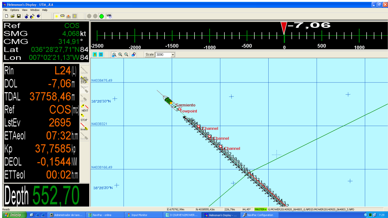
Figura 5. Visualización y control a tiempo real de la posición del barco, “streamer” y fuente sísmica.
