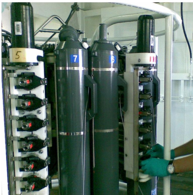
Figura: Sistema de botellas presurizadas de la Univ. de Viena
