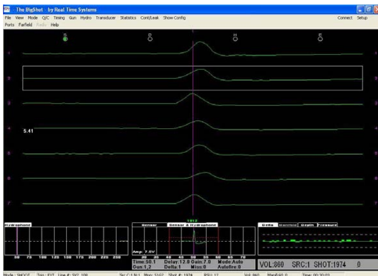
Figura 5. Detalle de funcionamiento del controlador de cañones BigShot.
