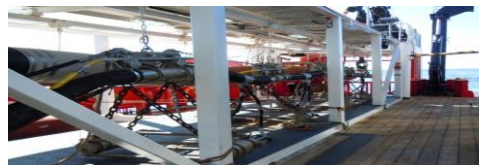
Foto 2. Estructura de cañones diseñada y fabricada por UTM.
