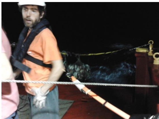
Im 18. Flotador enganchado al streamer.
