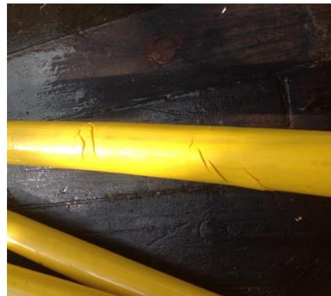
Im. 26. Cortes en la sección activa
