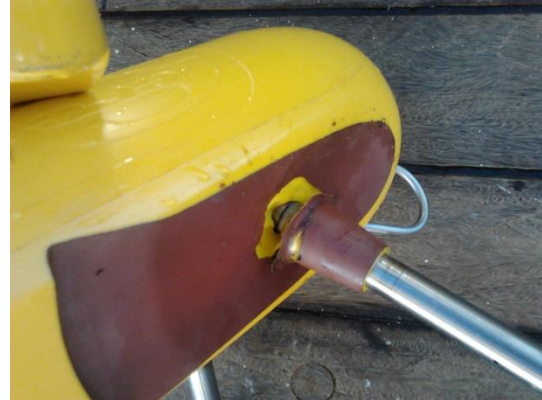
Im. 24. Daño en el eje del ala
