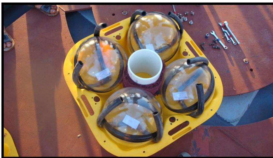
Imagen 2. Inspección y sustitución de tres de las esferas dañadas.
