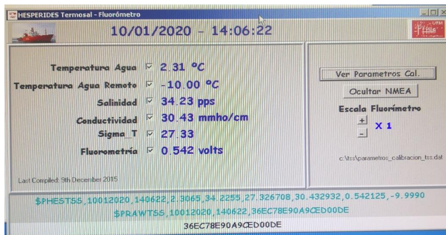
Pantallazo del programa de adquisición TSS-SADO funcionando correctamente con el nuevo TSS 3466.
