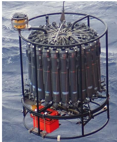
Imagen de la roseta con el CTD y sensores
