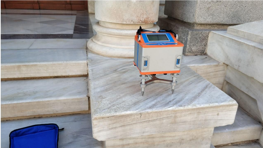
Gravímetro portátil calibrando en la entrada del ayuntamiento de Cartagena.
