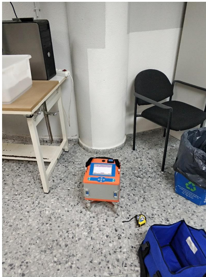
Foto del gravímetro portátil en el momento de la calibración en la Facultad de Ingeniería de la ULPGC.
