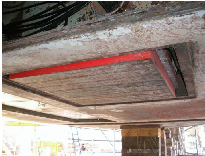
IMAGEN DEL TRANSDUCTOR DE LA TOPAS EN EL BIO HESPERIDES.
