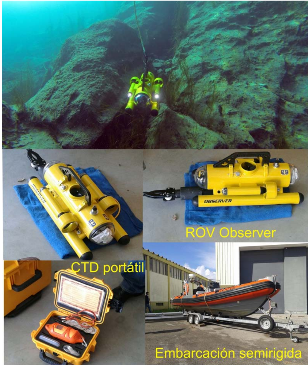
FIGURA 3: Metodología a utilizar durante las fases 1 y 2 con el mini-ROV Explorer, con capacidad de inmersión hasta 150 metros, a bordo de una embarcación semirígida dotada con sonda multihaz que aporta EMEPC. Se muestra también la sonda CTD portátil para la caracterización de las emisiones.
