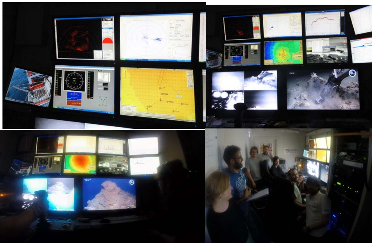
FIGURA 4: Controles del ROV Luso. Arriba izquierda: radar, situación GPS y altímetro. Arriba derecha: cámaras de popa y principal de alta resolución y sensores CTD y de CO 2 y metano. Abajo: sistema de joystick del ROV y pantallas de control.
