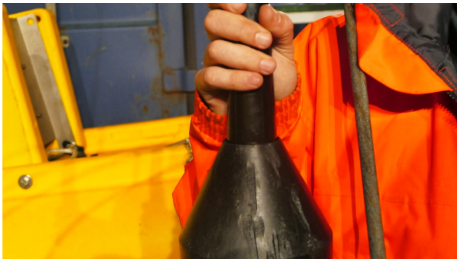
Fotos 15 y 16. Imágenes de los roces que traía el magnetómetro y pudieron ser los causantes del fallo del mismo.
