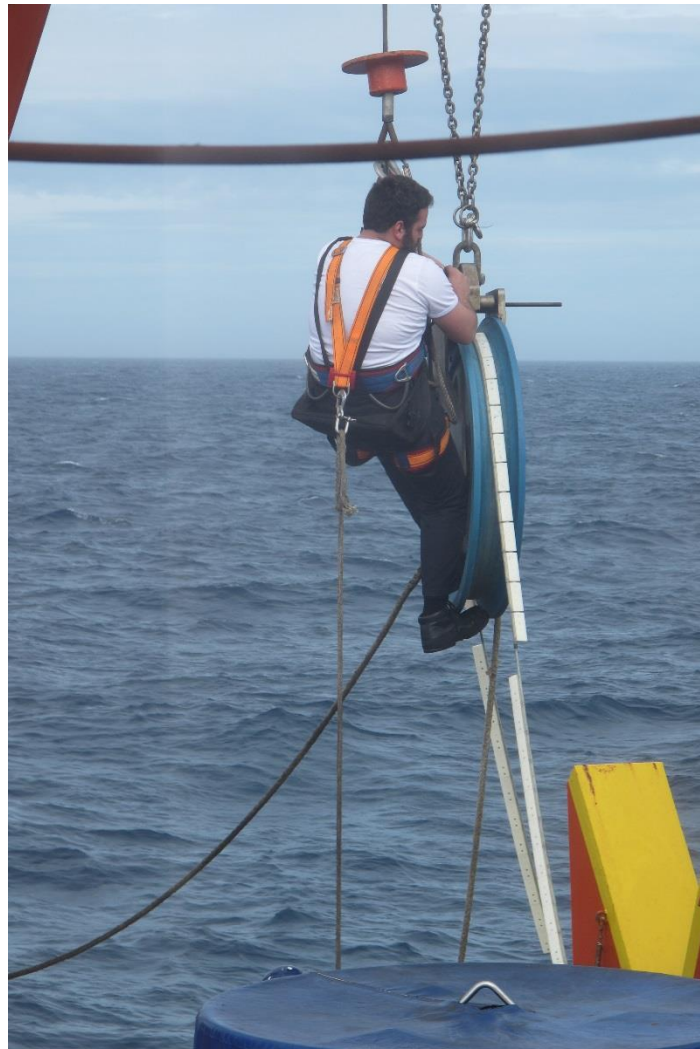
Marinero recolocando el cable en la pasteca e instalando varillas para el cierre.
