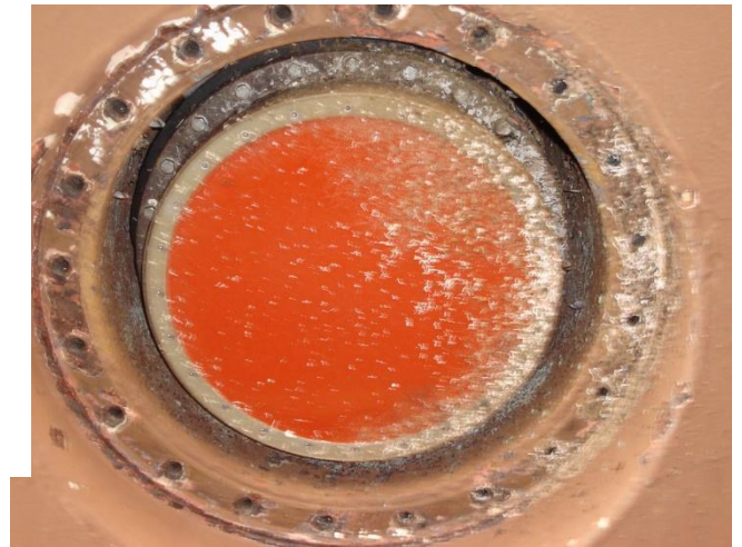
Imágenes del Doppler de 75 KHz, a la derecha el transductor en el casco del BIO Hespérides.
