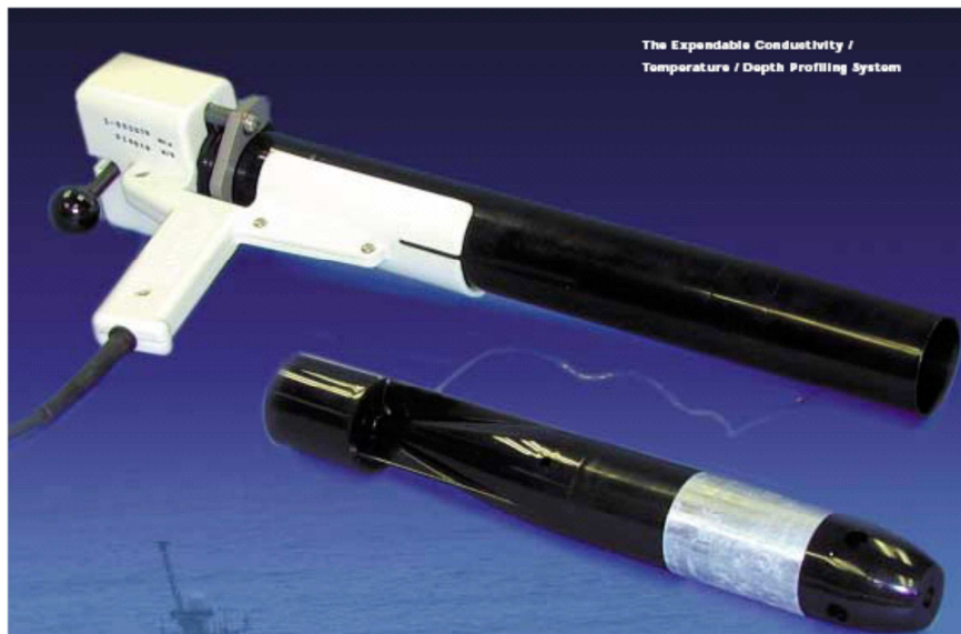
Imagen 12: Imagen de la pistola de lanzamiento de las sondas batitermográficas.
