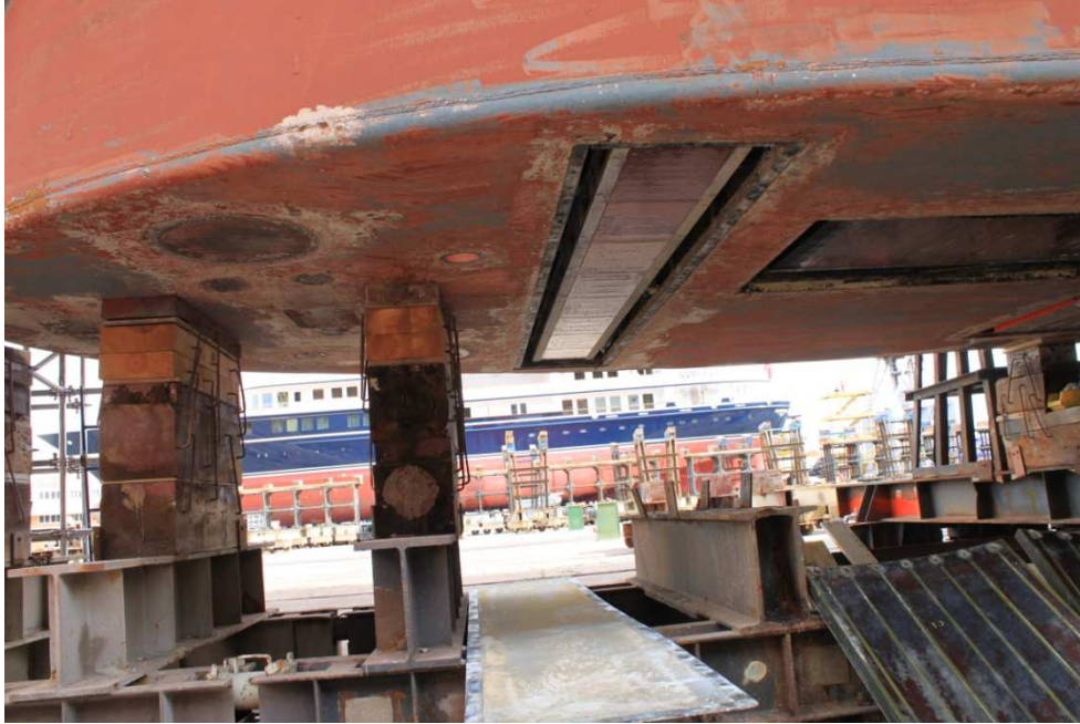
Imagen 3 :Imagen de los transductores de recepción y emisión en la barquilla del Hespérides.
