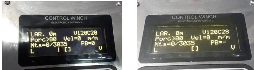
Como se puede apreciar en las fotos de dos maniobras diferentes, justo antes de empezar en una estamos en la capa 20 y en otra en la 28, y si nos fijamos en la foto de arriba, que fue finalizando una maniobra la capa es la 22 y la vuleta se queda en 1.
